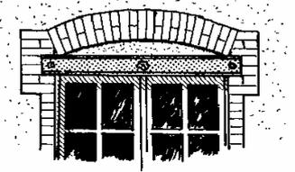
linteau métallique, sous un arc de décharge en briques
