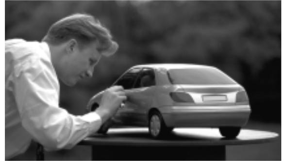
Désormais conçues par informatique (C.A.O - D.A.O. conception et dessin assistés par ordinateur), les carrosseries sont d'abord réalisées en maquette à échelle réduite, ce qui permet de réaliser des essais en soufflerie, pour un coût réduit. Ensuite seulement, on réalise une maquette grandeur nature.
