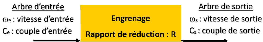
Figure 52. Fonction d'un engrenage.
