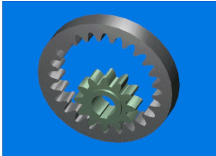
Figure 56. Engrenage intérieur.
