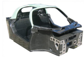
Châssis monocoque en composite Ferrari Enzo
