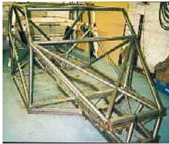
Châssis tubulaire: treillis de barres
