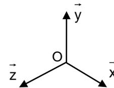
**NB :** Un trait parallèle à un axe dans une vue plane, doit être parallèle à ce même axe dans la perspective.
