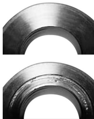
Figure 5.4 : Détérioration des surfaces de contact lors du montage-démontage
