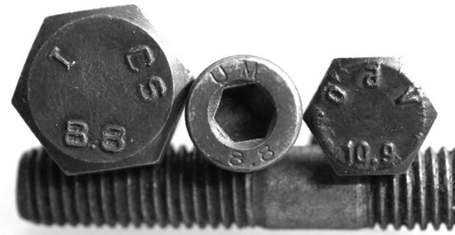
Figure 4.1 : Marquage des vis montrant la classe de qualité
