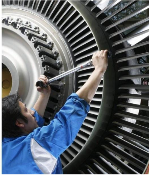
Serrage à la clé dynamométrique
