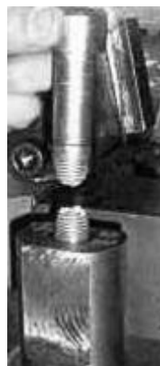
Figure 5.5 : Rupture de la vis
