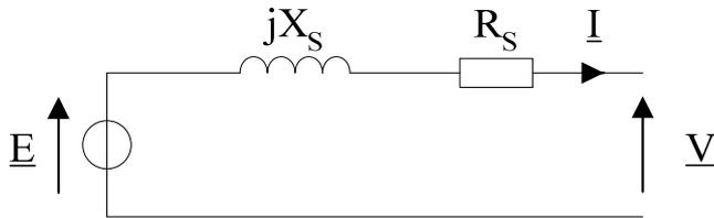
La résistance de l'enroulement de l'induit est :  $R_s = 0,3 \Omega$ .
