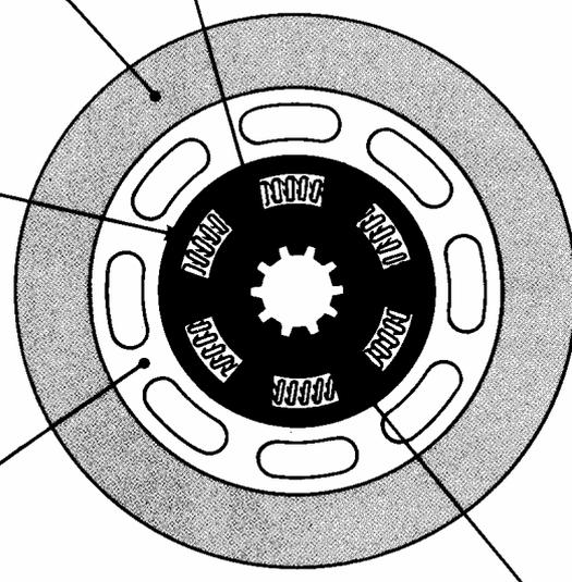
*Les deux rondelles de guidage sont rivées sur le moyeu*
