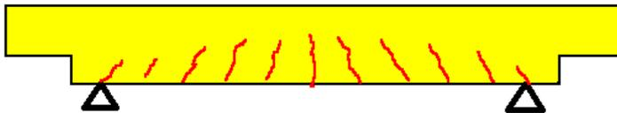
mode de rupture par flexion en configuration 3 (poutre A et B)
