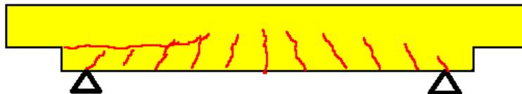
mode de rupture par décollement en configuration 3 (poutre C)
