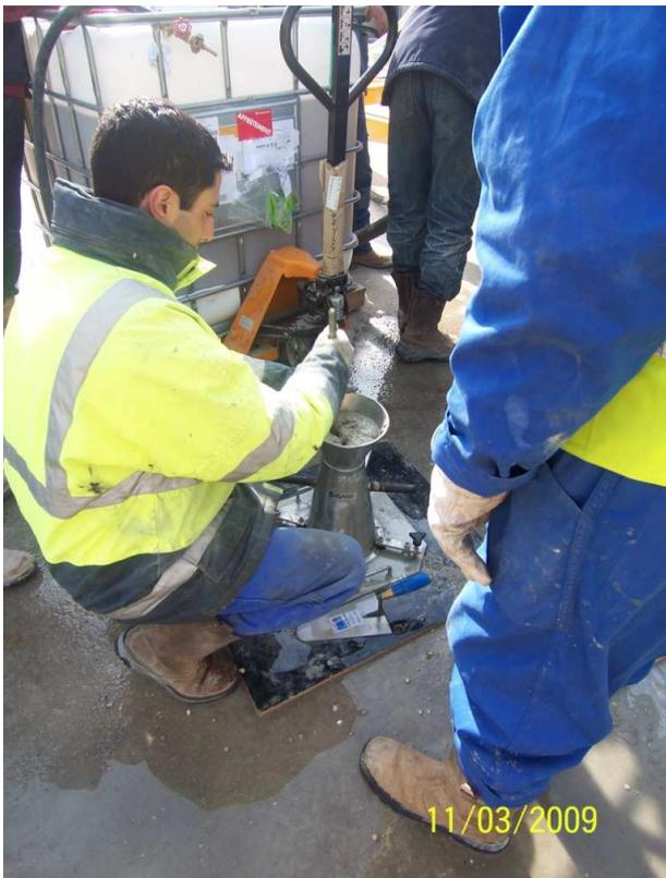
Piquage tige Ø 16 dans le cône rempli de béton
