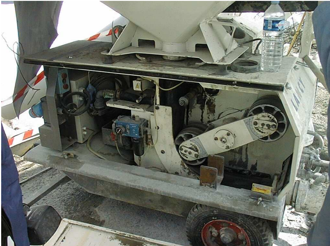
Vue de l'intérieur d'une machine à tuyau écrasé
