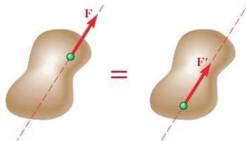
A la section A, nous avons représenté par des vecteurs les forces agissant sur une particule. Le point d'application, la particule elle-même, restant fixe, les vecteurs sont liés. Dans le cas des corps rigides, on peut déplacer la force sur sa ligne d'action, sans conséquence sur l'effet produit. On a donc affaire à des **vecteurs glissants**.
