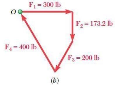
et arrangement des forces de mode d'incliner-à-queue, nous constatons que le bout de  $\vec{F}_4$  coïncide avec le point de départ O. Ainsi, la **résultante  $\vec{R}$**  du système de forces indiqué est nulle, et la particule est dans l'équilibre. Le polygone fermé dessiné dans la figure b fournit une expression graphique de l'équilibre de A. Pour exprimer algébriquement les conditions d'équilibre d'une particule, nous écrivons :
