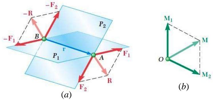
De même, nous pouvons supposer que le couple dans  $P_2$  se compose de deux forces  $\vec{F}_2$  et  $-\vec{F}_2$ , perpendiculaire à AB et agissant respectivement en A et en B. Il est clair que la **résultante**  $\vec{R}$  de  $\vec{F}_1$  et  $\vec{F}_2$  et la **résultante**  $-\vec{R}$  de  $-\vec{F}_1$  et  $-\vec{F}_2$  forme un couple. En posant  $\vec{r} = \vec{BA}$ , nous exprimons le moment  $\vec{M}$  des couples résultants comme:
