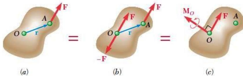
Nous pouvons, cependant, attacher deux forces au point O une égale à  $\vec{F}$  et à l'autre égale à  $-\vec{F}$  sans modifier l'action de la force originale sur le corps rigide (figure b ci-dessus). En raison de cette transformation, nous avons maintenant une force  $\vec{F}$  appliquée en O les deux autres forces forment un couple de moment  $\vec{M}_o = \vec{r} \wedge \vec{F}$ . Ainsi :
