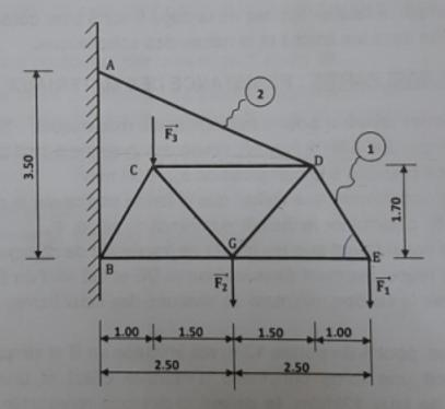
La conception d'un abri dans le chantier d'ENAMSON a abouti à une ossature porteuse métallique représentée par la figure ci-dessus. La ferme BCDEG 1 est articulée en B sur le mur et est retenue au-dessus par un câble DA 2 dont la section est circulaire. Le chargement est celui indiqué sur la figure 1 et les forces ont pour intensités
